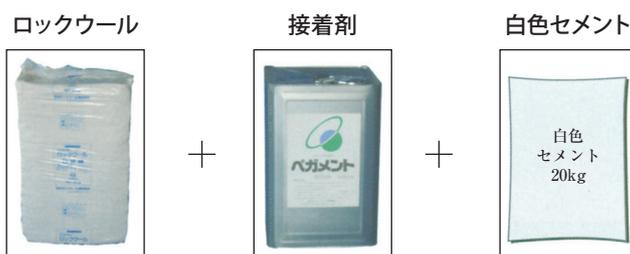
エコダンネットDKGL® 工法を構成する材料は、DKGL® 専用機を使用し、断熱用材のロックウール粒状綿と接着剤を強化する専用接着剤ペガメントと、白色セメントです。専用接着剤を加えたセメントスラリーとロックウールを同時に吹付けます。さらに、強度を高めるために表面にもセメントスラリーを吹付けます。
